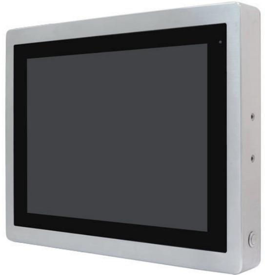
Der lüfterlose Touch-PC ist mit einer Intel<sup>®</sup> Celeron<sup>™</sup> QuadCore N2930 CPU ausgestattet, die genügend Rechenleistung für aufwendige Applikationen aus Bereich der industriellen Automation bietet. Das Gehäuse ist aus rostfreiem Stahl mit rundum IP66/IP69K und ermöglichen somit einen Einsatz in rauen und sensiblen industriellen Umgebungen, wie etwa der Lebensmittelindustrie.
