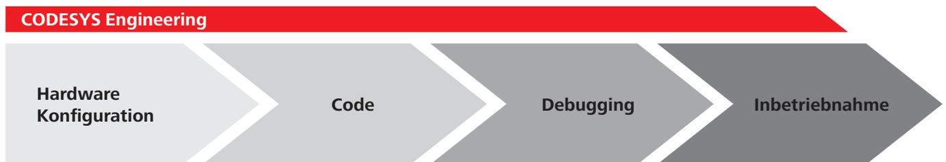
Die klassische Programmierung einer Applikation durchläuft verschiedene Phasen. CODESYS unterstützt den Anwender von der Konfiguration bis zur Inbetriebnahme. Zur methodischen Unterstützung der Softwareentwicklung eignen sich die integrierbaren Zusatztools der CODESYS Professional Developer Edition.
